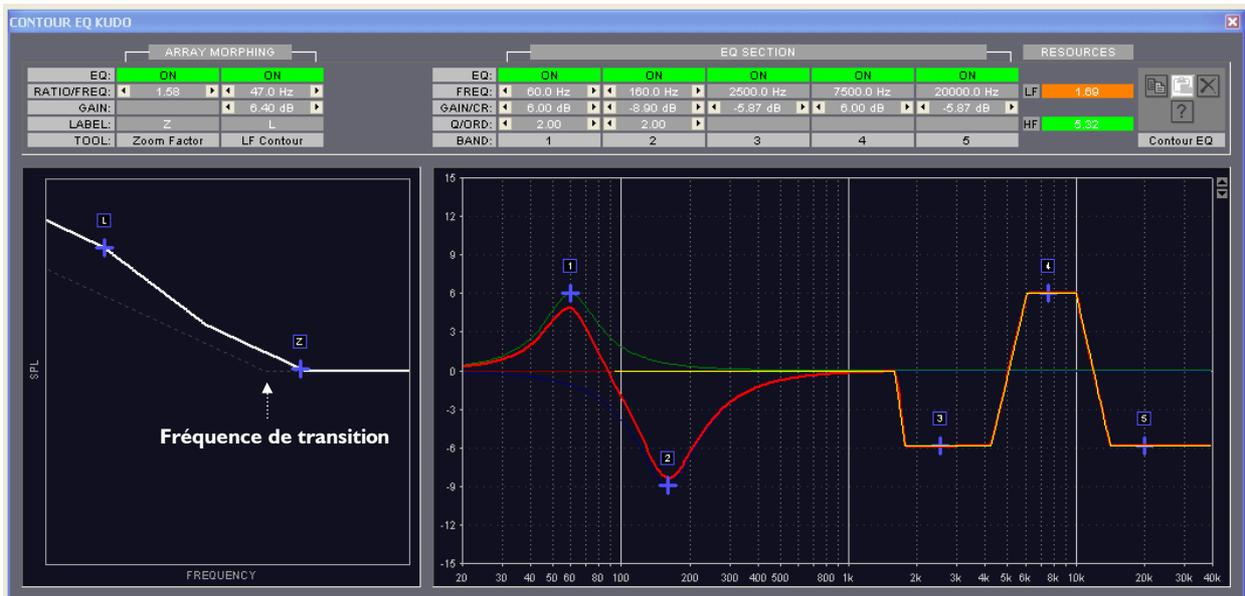
Figure 4: La fenêtre CONTOUR EQ
